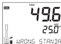
Wenn die Temperatur während der Kalibrierung außerhalb des Bereichs (0,0 - 50,0 °C) liegt, wird die Meldung „WRONG STANDARD TEMPERATURE“ angezeigt und der Temperaturwert blinkt.
