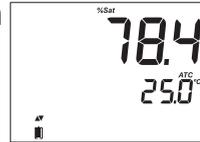
3. Drücken Sie die **RANGE/ ►**-Taste, um den Messwert von % in ppm (mg/L) zu ändern und umgekehrt.
