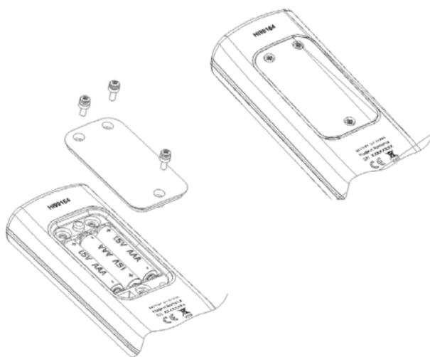
Reemplace las tres pilas alcalinas AAA de 1.5V ubicadas en el compartimiento de las pilas, respetando la polaridad indicada.
