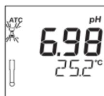
La pantalla LCD muestra el valor de pH (compensado automáticamente por temperatura) en la pantalla LCD principal, mientras que la pantalla LCD
