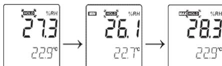
Para cambiar entre las mediciones de humedad relativa y punto de rocío (solo HI9565) presione brevemente el botón
