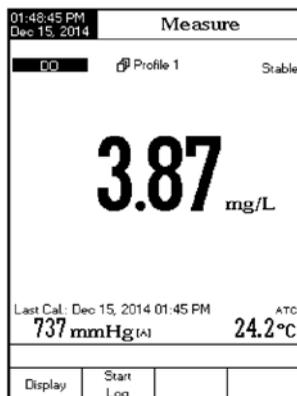
Hinweis: Für eine genaue Messung des gelösten Sauerstoffs muss die Messlösung mit einer Fließgeschwindigkeit von 0,3 m/s in Bewegung sein. So wird sichergestellt, dass der Sauerstoff an der verarmten Membran kontinuierlich nachgeliefert wird.
