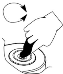
2. Usando uma pipeta de plástico, coloque a amostra na superfície do prisma. Encha o poço completamente.
