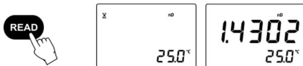
*Nota: O valor da última medição será exibido até que a próxima amostra seja medida ou o instrumento seja desligado. A temperatura será continuamente atualizada. A tag ATC pisca e a compensação automática de temperatura é desabilitada se a temperatura exceder a faixa de 10,0 - 40,0 °C / 50,0 - 104,0 °F.*
