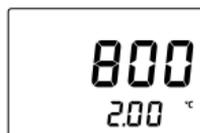
2. Enquanto continua a pressionar a tecla **ON/OFF**, pressione a tecla **ZERO**. A unidade de temperatura mudará de °C para °F ou vice versa.
