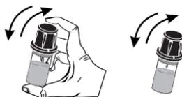
Afin d'éviter les fuites de réactifs et d'obtenir des mesures plus précises, fermer d'abord la cuvette avec le bouchon en plastique HDPE fourni
