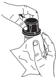
Scuotendo la cuvetta si possono generare delle bolle d'aria all'interno del campione che porterebbero a letture errate. Per ottenere misure accurate, rimuovere le bolle agitando o toccando delicatamente la cuvetta con le dita.
