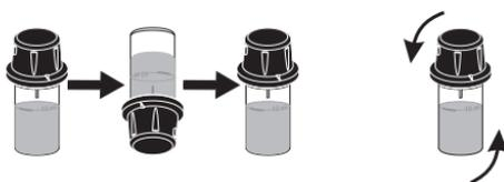
Per evitare perdite di reagente e ottenere misure più precise, chiudere la cuvetta con il sottotappo in plastica HDPE
