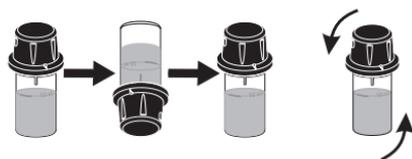
Per evitare perdite di reagente e ottenere misure più precise, chiudere la cuvetta con il sottotappo in plastica HDPE
