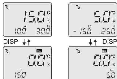
In modalità relativa, il livello principale del display mostra la differenza dalla temperatura di riferimento, mentre quello secondario visualizza la temperatura corrente del canale selezionato.
