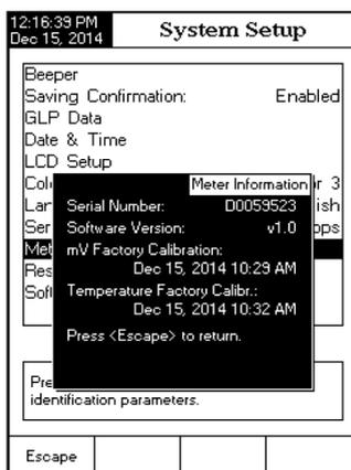
**Nota:** Tutti gli strumenti sono calibrati in fabbrica per mV e temperatura. Un anno dopo la calibrazione di fabbrica, si visualizzerà il messaggio di avviso "Factory Calibration Expired" ("Calibrazione di fabbrica scaduta") all'accensione dello strumento. Lo strumento funzionerà comunque, ma è necessario rivolgersi al centro di assistenza Hanna più vicino per la calibrazione di fabbrica.
