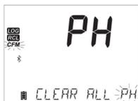
Premere il tasto **RCL**. Il display visualizza **CFM** e il parametro *PH* lampeggianti.
