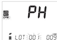
Utilizzare i tasti **FRECCIA ▲** e **▼** per scorrere tra i diversi dati registrati. Premere **CFM** per entrare e per visualizzare i dettagli dei dati memorizzati.
