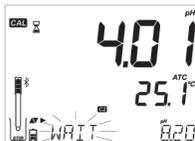
Il valore del tampone inizierà a lampeggiare. Utilizzare i tasti **FRECCIA** per cambiare il valore del tampone.
