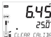
Per eliminare i dati premere invece il tasto **CFM**. Si visualizzerà il messaggio "CLEAR ALL" seguito dal messaggio "CAL DUE".
