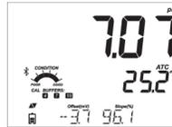
Il valore di pH è visualizzato sul primo livello del display e la temperatura sul secondo livello. Utilizzando le frecce, si possono visualizzare sul terzo livello del display: data, ora, stato della batteria, offset e slope. Se la lettura è fuori scala, il valore di fondo scala più vicino apparirà lampeggiante sul primo livello del display.
