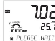
Lo strumento visualizza brevemente "PLEASE WAIT", poi comparirà il simbolo di stabilità (clessidra), "LOG" e il messaggio "WAITING". La registrazione può essere interrotta durante la visualizzazione del messaggio "WAITING", premendo nuovamente **LOG** o il pulsante della sonda.
