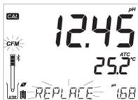
Se il tampone utilizzato non ha alcun precedente dato salvato e la calibrazione non è completa (a cinque punti), il tampone corrente viene aggiunto alla calibrazione esistente. Se la calibrazione esistente è già a 5 punti, lo strumento chiede quale tampone si vuole sostituire (Replace).
