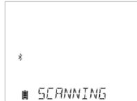
Lo strumento trova le sonde disponibili e le visualizza immediatamente. L'utente scorrendo con i tasti freccia ▲▼ può connettere una sonda, utilizzando il tasto GLP/CFM.
