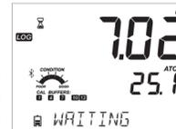
Quando la lettura è stabile secondo il criterio di stabilità selezionato, sarà visualizzato il messaggio "SAVED", che indica che la misurazione è stata registrata, con indicazione del numero di log progressivo.
