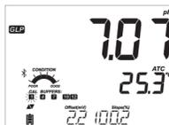
Premendo i tasti freccia ▲▼, si visualizza la data dell'ultima calibrazione insieme alla lettura corrente.
