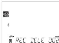
Lo strumento visualizzerà "REC DELETED PRESS CAL TO UNDO", o **RCL** per salvare le modifiche e non saranno visualizzati e valori misurati. È possibile cancellare più dati, premere il pulsante **CAL/MODIFY** per ogni dato eliminato.
