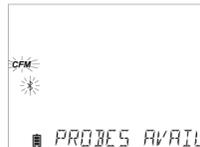
SCANSIONE MANUALE: in modalità di misura, per effettuare una scansione manuale, selezionare SCAN con i tasti freccia ▲▼ e premere GLP/CFM. Si continuerà a visualizzare "SCANNING" finchè non viene rilevata una sonda (premere SETUP/CLR per tornare in modalità di misura).
