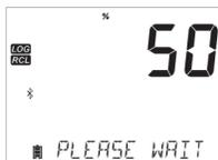
Premere **CLR** mentre il display visualizza il simbolo del parametro lampeggiante e il messaggio "LOG RECALL". Appaia quindi il messaggio "CLEAR ALL", insieme a *pH* e *CFM* lampeggianti. Premere **CFM**.
