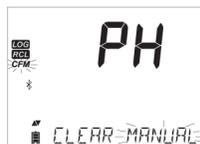
Selezionare il lotto Manuale (o di Stabilità) quindi premere **CLR**. Sarà visualizzato sul display il messaggio "CLEAR" seguito da "MANUAL" o "STABILITY" e "CFM" lampeggiante. Premere **CFM** per confermare l'eliminazione del lotto selezionato (Manuale o di Stabilità) o tutti i record. Premere **CLR** per uscire senza cancellare.
