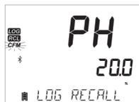
È possibile eliminare tutti i dati in un'unica azione. Questa funzione permette di eliminare tutti i dati registrati nella memoria Manuale, di Stabilità e ad Intervalli per il parametro selezionato.
