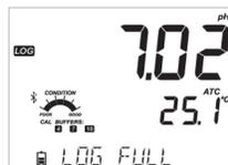
Nel menù **SETUP** selezionare "log parameter", premere **MODIFY** e utilizzare il tasto freccia ► per selezionare la modalità di registrazione. Quando è visualizzato *Interval*, utilizzare le frecce ▲ e ▼ per impostare l'intervallo di tempo. Quando è visualizzato *Stability*, utilizzare le frecce ▲ e ▼ per selezionare l'impostazione di stabilità di misura.
