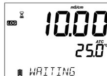
Lo strumento visualizza brevemente "PLEASE WAIT", poi comparirà il simbolo di stabilità (clessidra), "LOG" e il messaggio "WAITING". La registrazione può essere interrotta durante la visualizzazione del messaggio "WAITING", premendo nuovamente **LOG**.
