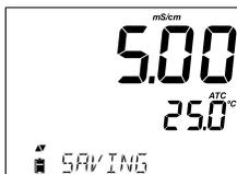
Premere **CFM** per confermare la calibrazione. Lo strumento visualizzerà il messaggio "SAVING", memorizzerà automaticamente la calibrazione e tornerà alla modalità di misura.
