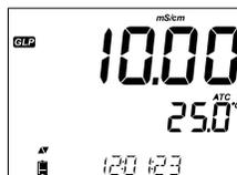
Data (yyyy.mm.dd.) dell'ultima calibrazione e lettura corrente.
