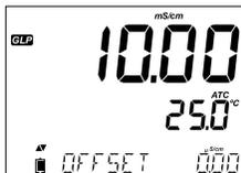
Offset di calibrazione in  $\mu\text{S}/\text{cm}$  insieme alla lettura corrente.
