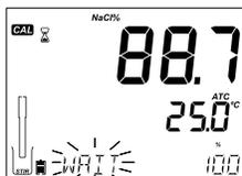
Premere **CAL** per entrare in modalità di calibrazione. Sarà visualizzato il simbolo "☞" insieme ai messaggi "STIR" e "CAL". Sul primo livello del display compare la misura percentuale di NaCl, sul secondo livello la temperatura e sul terzo livello il messaggio "WAIT" fino a quando la lettura non si stabilizza.
