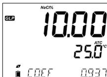
Il coefficiente di salinità determinato dalla calibrazione insieme alla lettura corrente.
