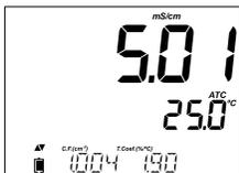
Il valore di conducibilità sarà visualizzato sul primo livello del display, la temperatura sul secondo livello e la calibrazione o le informazioni specifiche del parametro sul terzo livello del display (scorrere con i tasti freccia).
