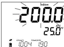
Se la lettura è fuori scala quando l'intervallo è impostato come automatico, sarà visualizzato il valore di fondo scala (200.0 mS/cm per modalità ATC o 500.0 mS/cm per la conducibilità assoluta) lampeggiante.
