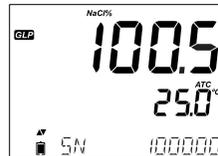
Utilizzare il tasto **RANGE** per passare da misura di conducibilità a TDS o a salinità.
