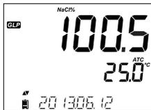
Data (yyyy.mm.dd.) dell'ultima calibrazione e lettura corrente.
