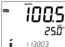
Ora (hh:mm:ss) dell'ultima calibrazione e lettura corrente.
