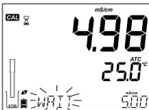
Premere **CAL** per entrare in modalità di calibrazione. Il messaggio "CAL" e il valore della soluzione standard riconosciuto dallo strumento compariranno sul terzo livello del display.
