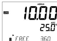
Premendo nuovamente il tasto **LOG** si fermerà la sessione di registrazione. Sarà visualizzato il messaggio "LOG STOPPED" per pochi secondi. Se si verifica un errore del sensore durante la registrazione, il messaggio "OUT OF SPEC." comparirà alternato alle informazioni di registrazione.
