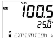
Se attivata, sarà visualizzato il numero di giorni che mancano alla scadenza della calibrazione (messaggio di allarme "CAL DUE").
