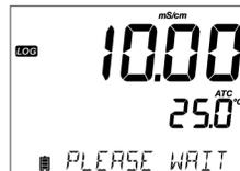
Nel menù SETUP selezionare *Stability* e scegliere il criterio di stabilità (Fast, Medium o Accurate). In modalità Basic è disponibile solo l'opzione Medium. Per avviare la registrazione con stabilità di lettura, premere il tasto **LOG** mentre lo strumento è in modalità di misura.
