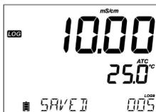
Selezionare *Manual* nel menù SETUP. Per avviare una registrazione manuale, premere il tasto **LOG** mentre lo strumento è in modalità di misura. Lo strumento visualizza brevemente "PLEASE WAIT", seguito dal messaggio "SAVED", che indica che la misurazione è stata registrata, con indicazione del numero di log progressivo.
