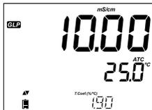
Coefficiente di temperatura impostato al momento della calibrazione insieme alla lettura corrente.
