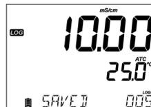
Quando la lettura è stabile secondo il criterio di stabilità selezionato, sarà visualizzato il messaggio "SAVED", che indica che la misurazione è stata registrata, con indicazione del numero di log progressivo.
