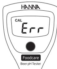
In modalità calibrazione, se la sonda si trova nella soluzione tampone corretta e viene visualizzato il messaggio "Err", la sonda deve essere pulita. Immergere la sonda nella soluzione di pulizia per 20 minuti. Sciacquare con acqua e idratare l'elettrodo nella soluzione di conservazione per almeno 30 minuti prima di eseguire la calibrazione.
