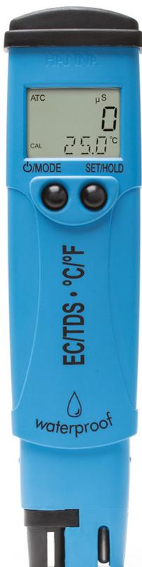
Bevor Sie diesen Tester verwenden, schrauben Sie das Batteriefach auf, um den Sicherheitsstreifen zu entfernen.
