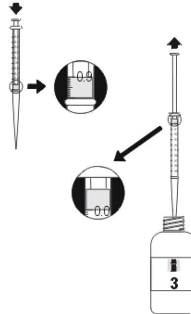
AUFZIEHEN DES HI 3811-0 REAGENZES IN DIE PIPETTENSPIITZE
