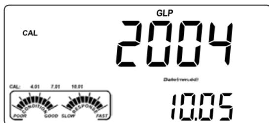
Presione las teclas de **FLECHA** para ver el siguiente parámetro de calibración (presionando la tecla **▲**):
