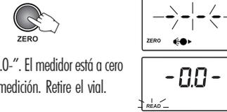
mostrará "0.0". El medidor está a cero y listo para medición. Retire el vial.
