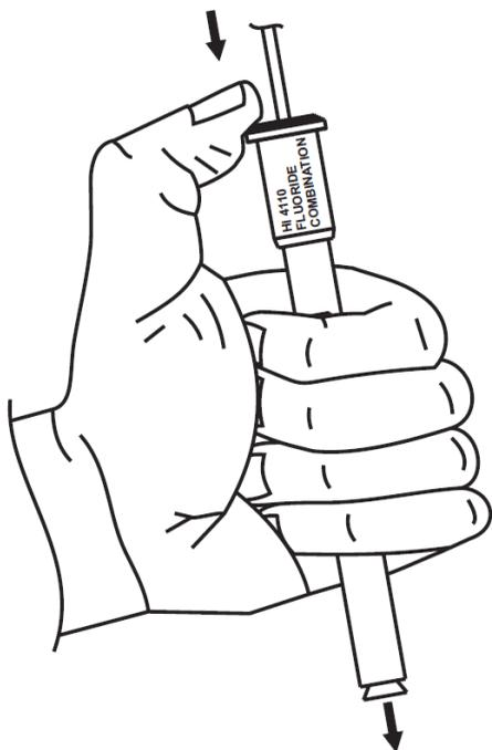
9. Drehen Sie die Elektrodenkappe fest und befüllen Sie den Elektrodenkörper bis kurz unter die Einfüllöffnung mit dem Elektrolyten **HI7075**.
