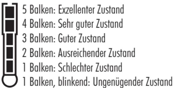
Spätestens bei Anzeige von nur einem Balken sollte die Elektrode gereinigt und neu kalibriert werden. Falls der Zustand sich nicht bessert oder ein blinkender Balken angezeigt wird, Elektrode austauschen.
