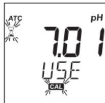
Das Gerät wechselt in den Kalibriermodus und zeigt die Meldung "pH 7.01 USE", **CAL** und das blinkende Symbol ⌚ an (für NIST wird "pH 6.86 USE" angezeigt).
