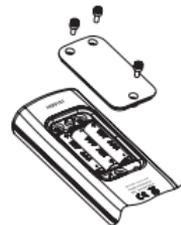
3. Batteriefachdeckel schließen und verschrauben.
