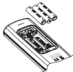
Beim Schließen des Batteriefachdeckels auf den korrekten Sitz der Dichtungen achten.
