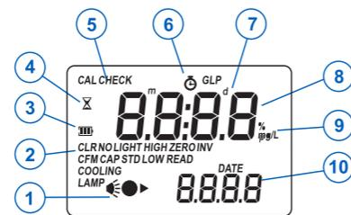
1. Messsymbole (Lampe, Küvette, Detektor). Erscheinen während der verschiedenen Phasen des Nullabgleichs oder der Messung
