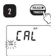
3. **ZERO/CFM** drücken, um auf Werkskalibrierung zurückzusetzen oder **GLP/▲** drücken um den Vorgang abzubrechen.
