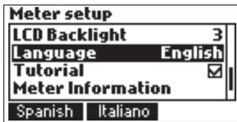
Drücken Sie die entsprechende Optionentaste, um die Sprache zu ändern. Wenn die gewählte Sprache nicht geladen werden kann, wird die zuvor gewählte Sprache geladen. Wenn keine Sprache beim Start geladen werden kann, wird das Gerät im "abgesicherten Modus" arbeiten. Im "abgesicherten Modus" werden alle Meldungen in Englisch angezeigt und Tutorial und Hilfe-Informationen können nicht zur Verfügung gestellt werden.
