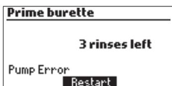
Diese Fehlermeldung erscheint, wenn die Pumpe nicht richtig funktioniert. Prüfen Sie den Schlauch, Ventil und Spritze. Drücken Sie Neustart, um es erneut zu versuchen.
