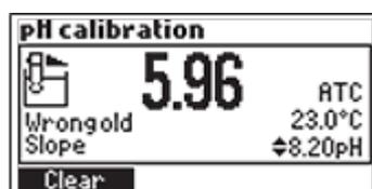
des Puffers (0 bis 45 °C) liegt, wird die "Wrong Buffer Temperatur" Fehlermeldung angezeigt und das Temperatur-Symbol auf dem Display fängt an zu blinken. Die Kalibrierung kann in diesem Fall nicht bestätigt werden.
